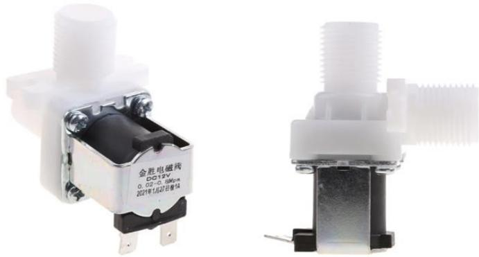
A l'état initial ou l'électrovanne est hors tension le noyau est maintenu sur le siège inférieur par le ressort il obture l'arrivée d'air, l'orifice de sortie est mis en communication avec l'échappement. Dès que l'électrovanne s'alimente le noyau est attiré par l'électro-aimant, il quitte le siège inférieur et vient obturer l'échappement ; et le fluide passe l'orifice d'entrée à l'orifice de sortie (Fig. II.6).[W17]
