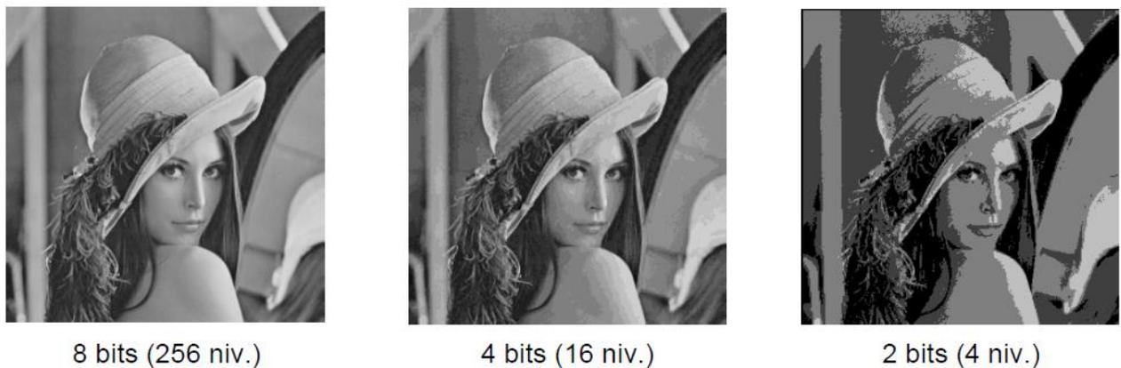
Figure 1.4 : Exemple de quantification sur 8 bits, 4 bits, 2 bits
