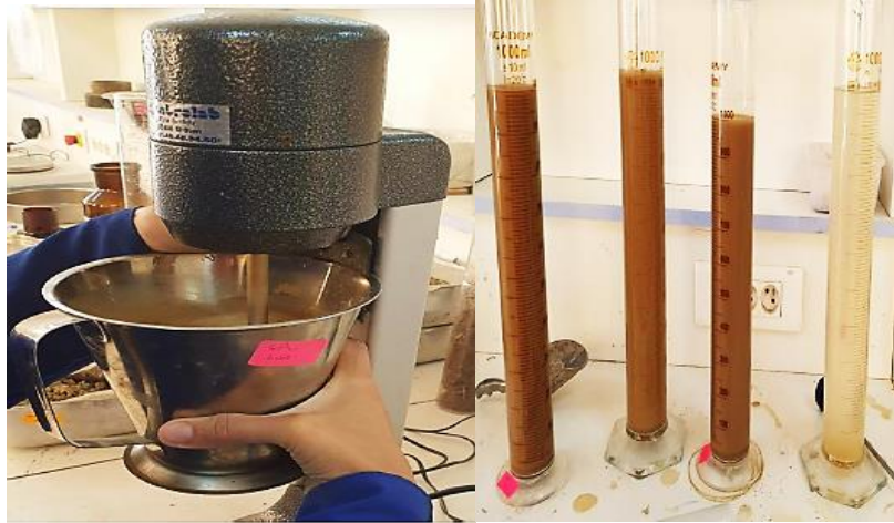
Figure 22 : Agitation de sol mécaniquement. Figure 23 : Eprouvettes de l'analyse.
