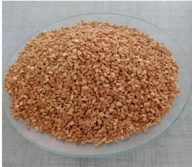
**Figure 06** : Coque du noyau d'abricot broyée et tamisée.
