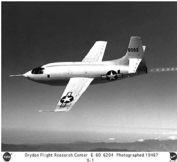
Fig. II.1 :l'avion-fusée volant en régime transsonique
