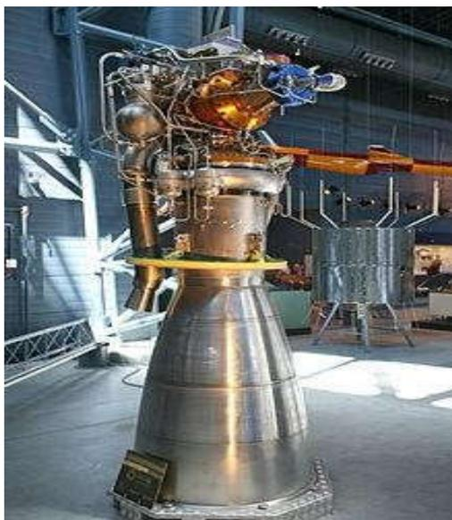
**Fig. I.12: moteur-fusée viking : au-dessus du divergent de la tuyère partie la plus volumineuse on distingue l'étranglement du col et le convergent qui se confond avec la chambre de combustion du moteur de forme cylindrique**
