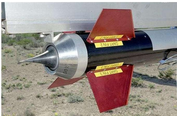
**Fig. I.10 : Tuyère annulaire non tronquée testée sur un moteur à propergol solide (2004)**
