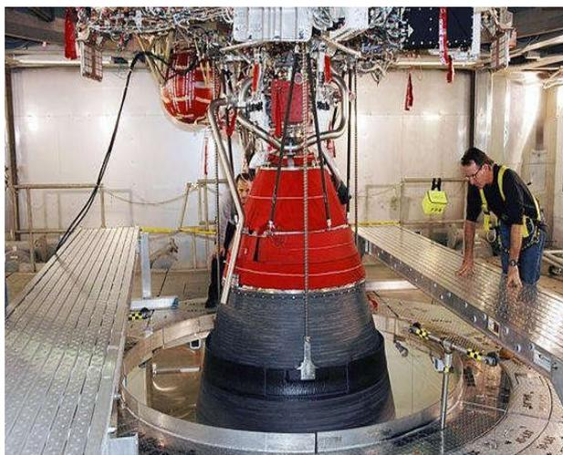
**Fig. I.9 : Test du déploiement de la partie extensible de la tuyère du moteur RL-10 B-2 propulsant le second étage du lanceur Delta IV.**
