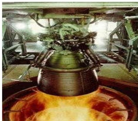
Fig. I.15 : Tuyère d'une fusée<sup>17</sup>
