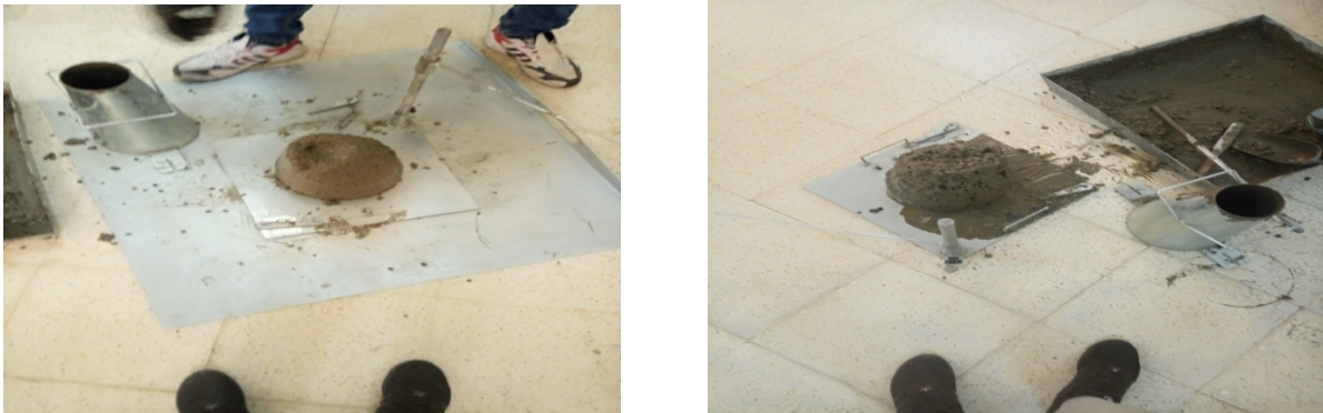
Figure 34: Mesure de l'affaissement au cône d'Abrams
