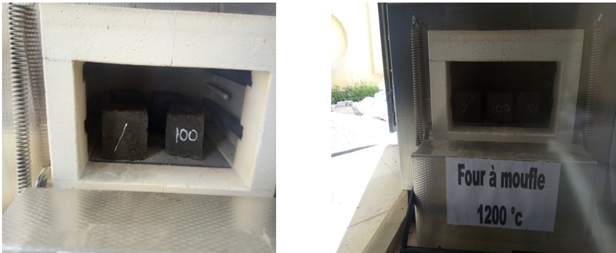
Figure 36: Application d'essai de traitement thermique
