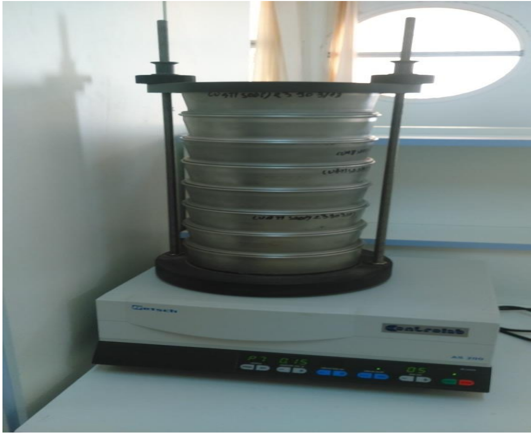
Figure III-2 : dispositifs d'essais d'analyse granulométrie labo du CUAT.
