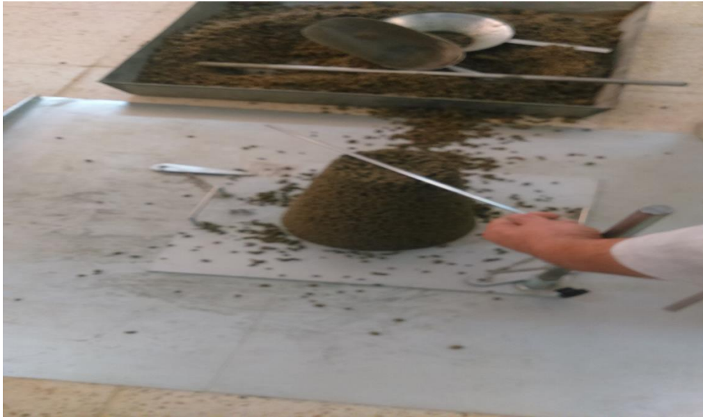
Figure III-5 : Essais d'affaissement au cône Abrams laboratoire CUAT.
