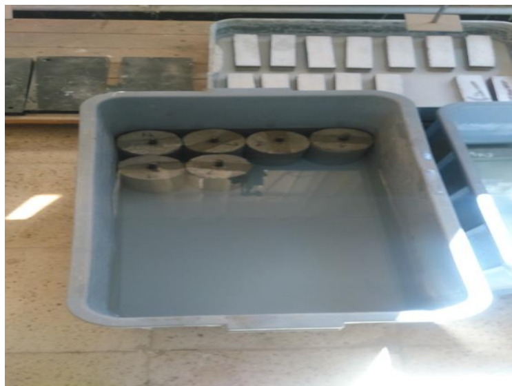
Figure III-4 : conservation des éprouvettes dans l'eau potable laboratoire CUAT.
