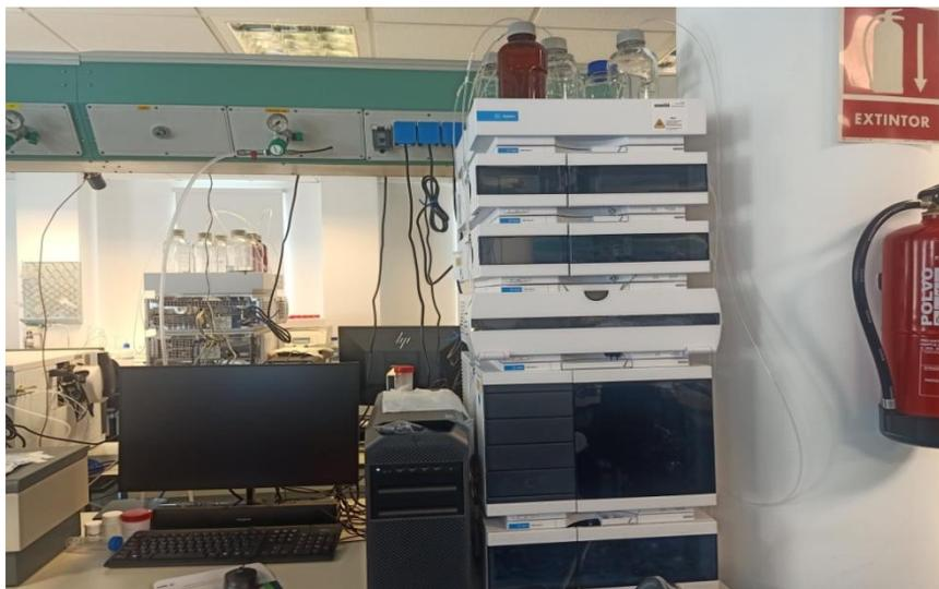
Figure II.5: La Chromatographie Liquide à Haute Performance (HPLC)
