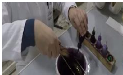
7/Recouvrir la lame avec Violet de Gentiane. 8/ Rincer le violet avec l'alcool, ajouter lugol
