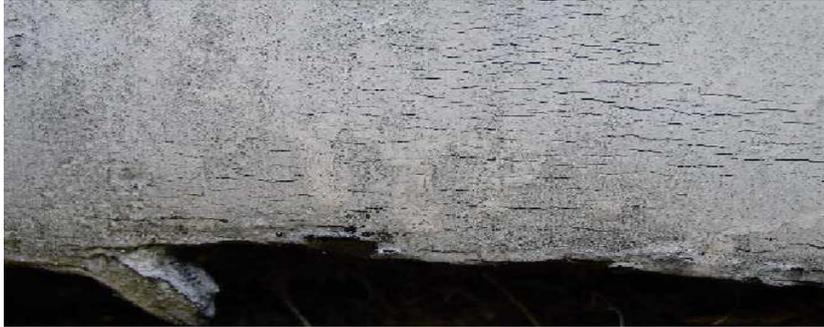
*Figure I.2 : Défaut de corrosion sur la paroi externe d'une canalisation métallique*
