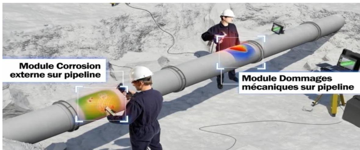
Figure II.1 : l'évaluation de l'intégrité des pipelines [29]
