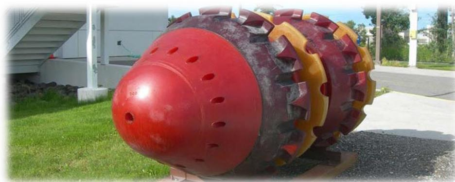
*Figure II.2 : racleur contrôleur géométriques*
