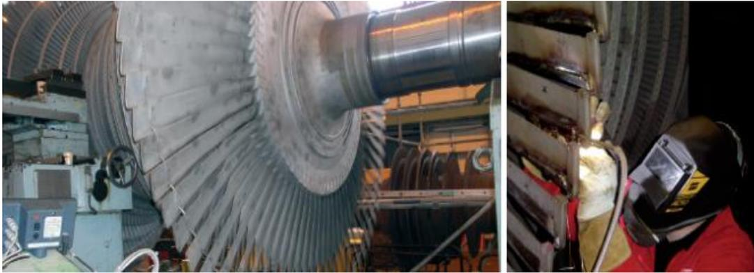
**Figure II- 16 :** Maintenance de turbine à vapeur[36].
