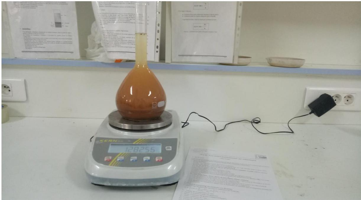
**Figure III.12.** Le pycnomètre.
