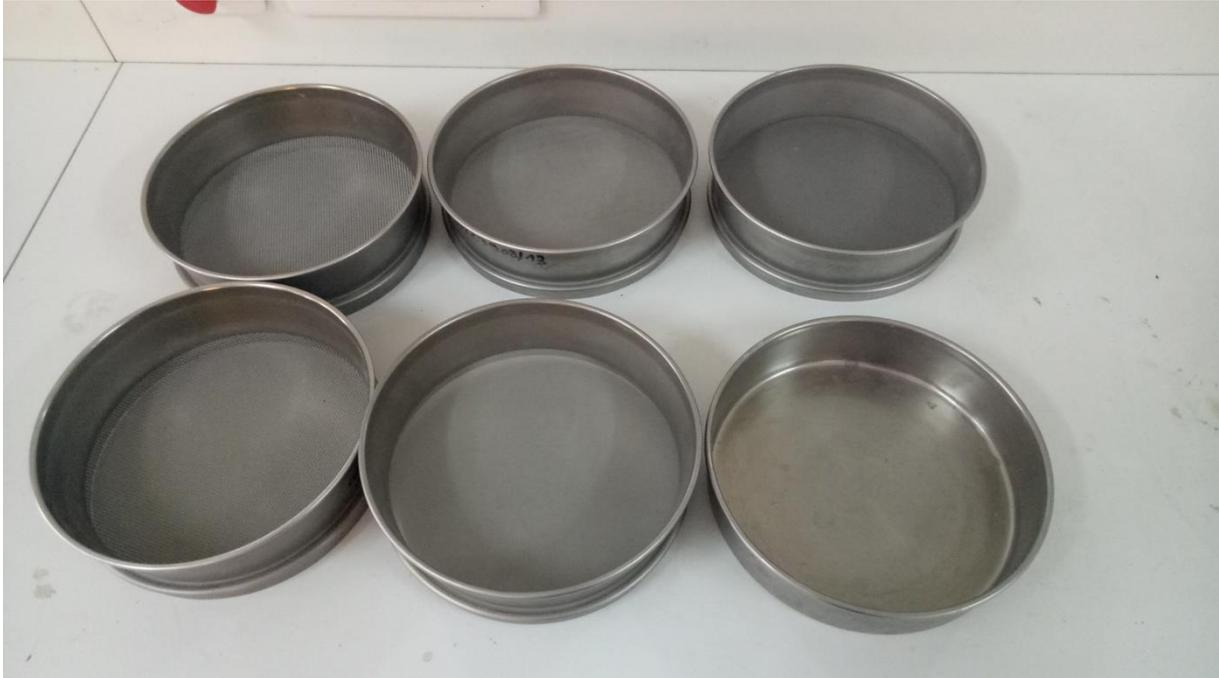
**Figure III.8.** Les tamis utilisés
