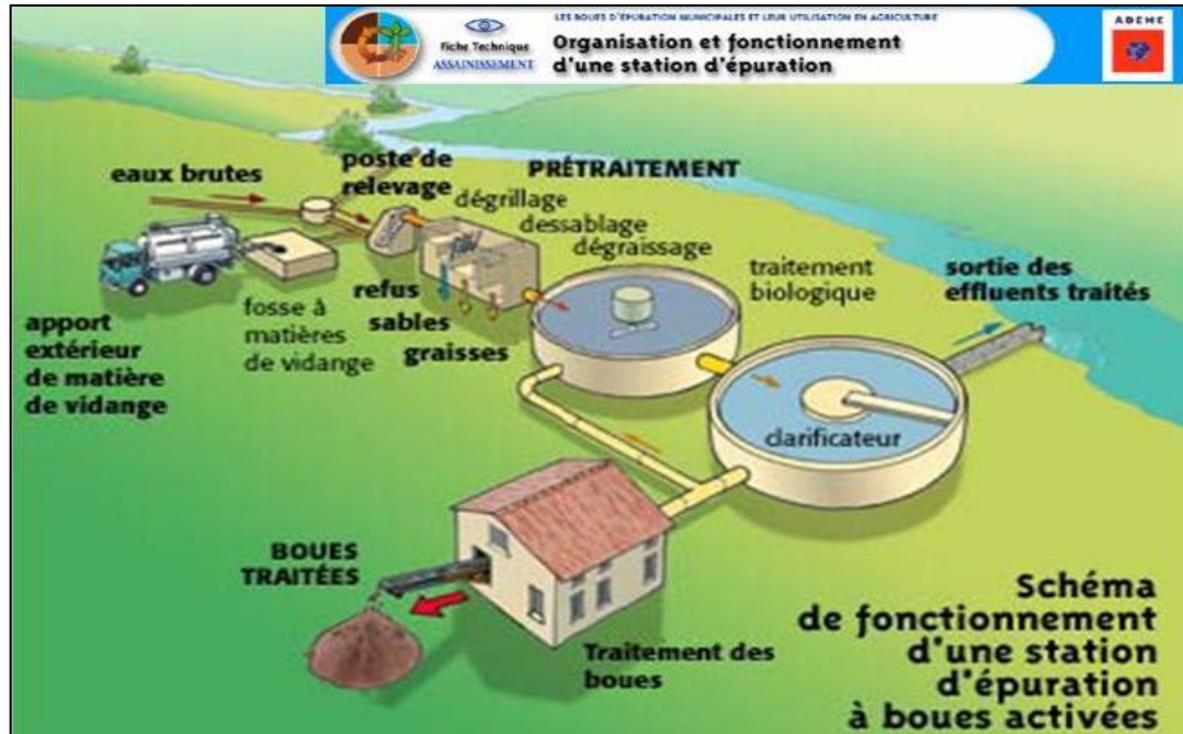
Figure I.2 : Représentation d'une station d'épuration domestique : vue d'ensemble.
