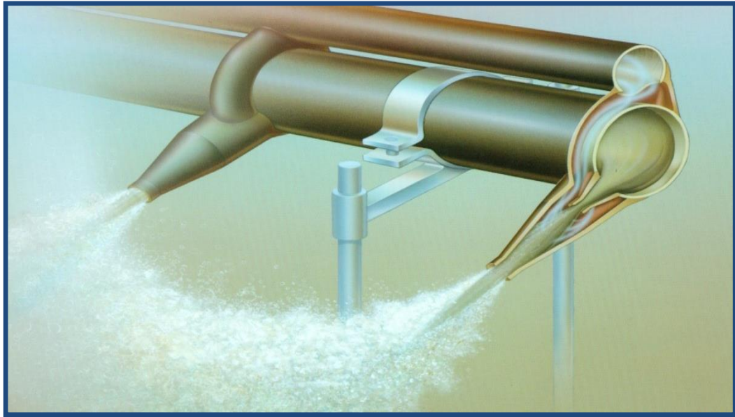
Figure III.8 : Schéma descriptif du L'aération par jet.
