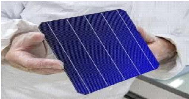
Figure (I-8) : Cellules en silicium monocristallin
