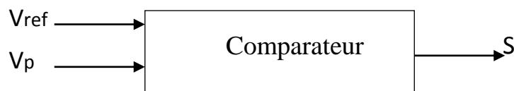
Figure VI.6 : Principe de la commande MLI d'onduleur.
