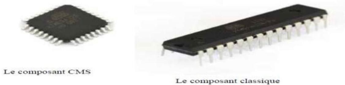
**La Figure II.6.** illustre un microcontrôleur ATmega328 de la carte Arduino Uno [6]
