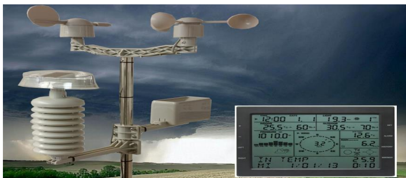
Figure I.3 –Exemple de station météorologique professionnelle. [15]
