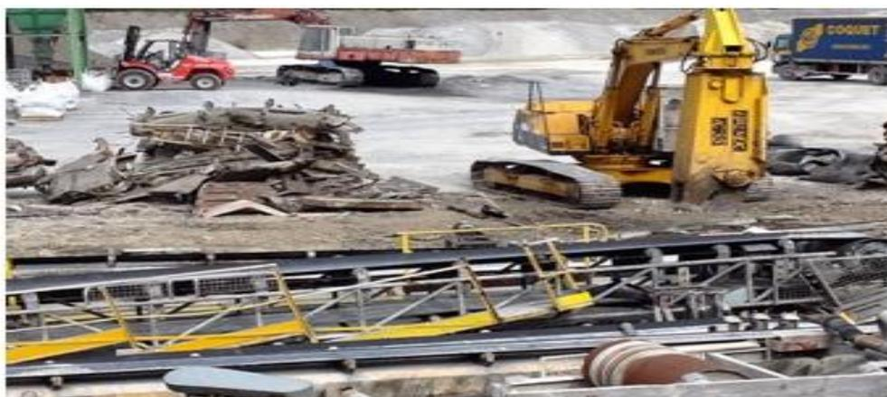
**Figure II-6 : station broyeur pour la ferraille**
