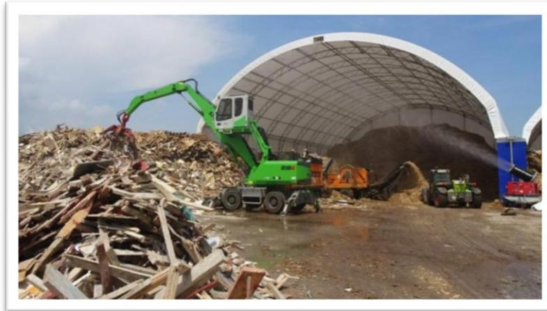
**Figure II-5 : installation de collection bois et broyeur**
