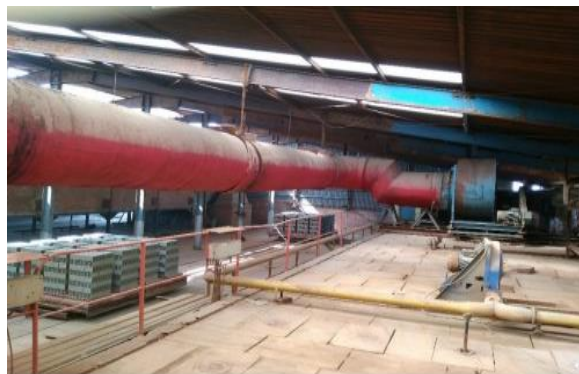
Figure 30 : Réutilisation des gaz produits par le four de cuisson
