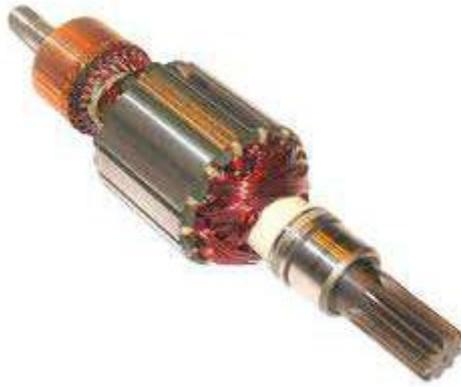
Figure I-4: Induit de la machine à courant continu
