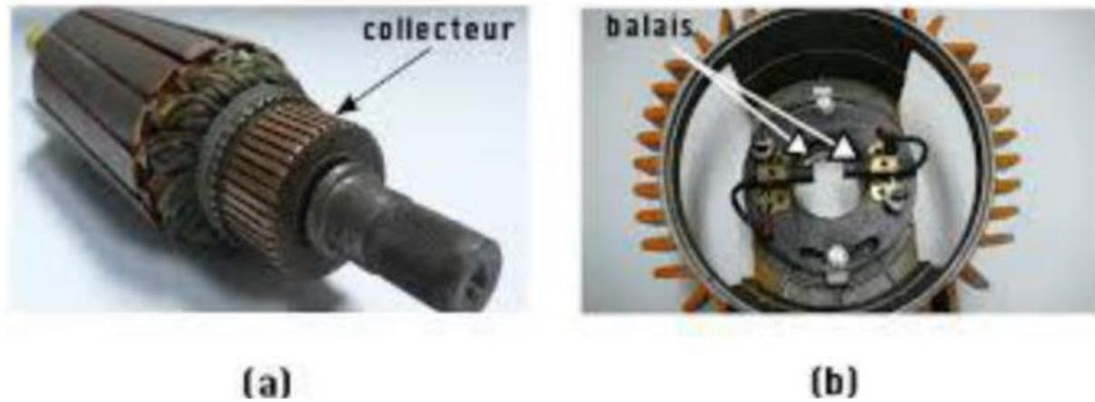
Figure I-5: Dispositif collecteur/balais de la machine à courant continu
