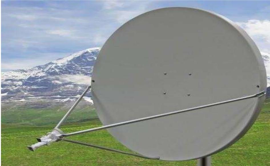
**Figure 6 :** Antenne à réflecteur parabolique. [7]
