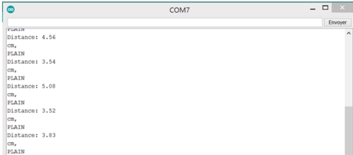
Figure 26: Résultat du test de niveau d'eau du réservoir.
