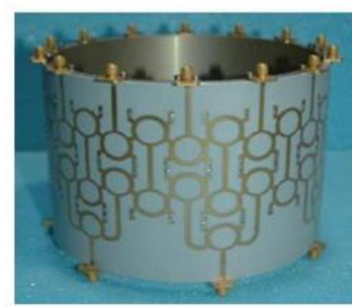
**Figure II. 17:** Réseau d'alimentation périodique refermé en technologie microruban [II-15].
