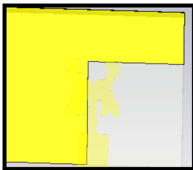
Figure III. 35 : Insertion de la fente dans le plan de masse.
