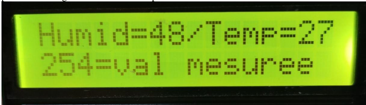
Fig.04.09 : Affichage des trois mesures température-humidité-qualité d'air
