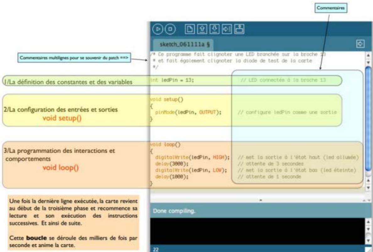
Fig. 3.19 : Structure d'un programme en Arduino [39]
