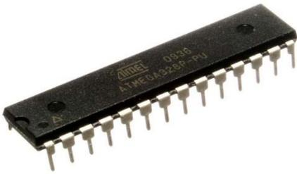
Fig. 3.4 : ATmega328P dans un boîtier double en ligne étroit à 28 broches (DIP -28N) [27]
