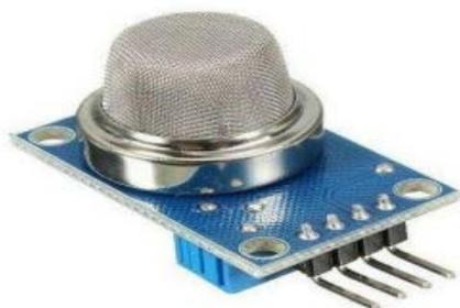
Fig. 3.11 : Capteur de qualité de l'air MQ-135 [32]
