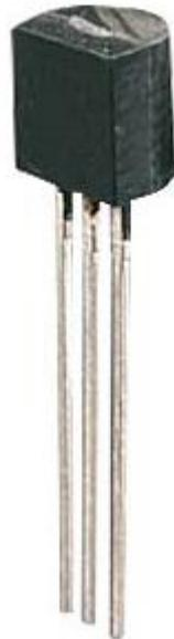
**Figure I.03** : Capteur LM335 [4]
