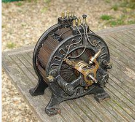
Figure I.2 :Ancien moteur à courant alternatif triphasé asynchrone à bagues, bobiné en anneau au stator, aux environs de 1910.
