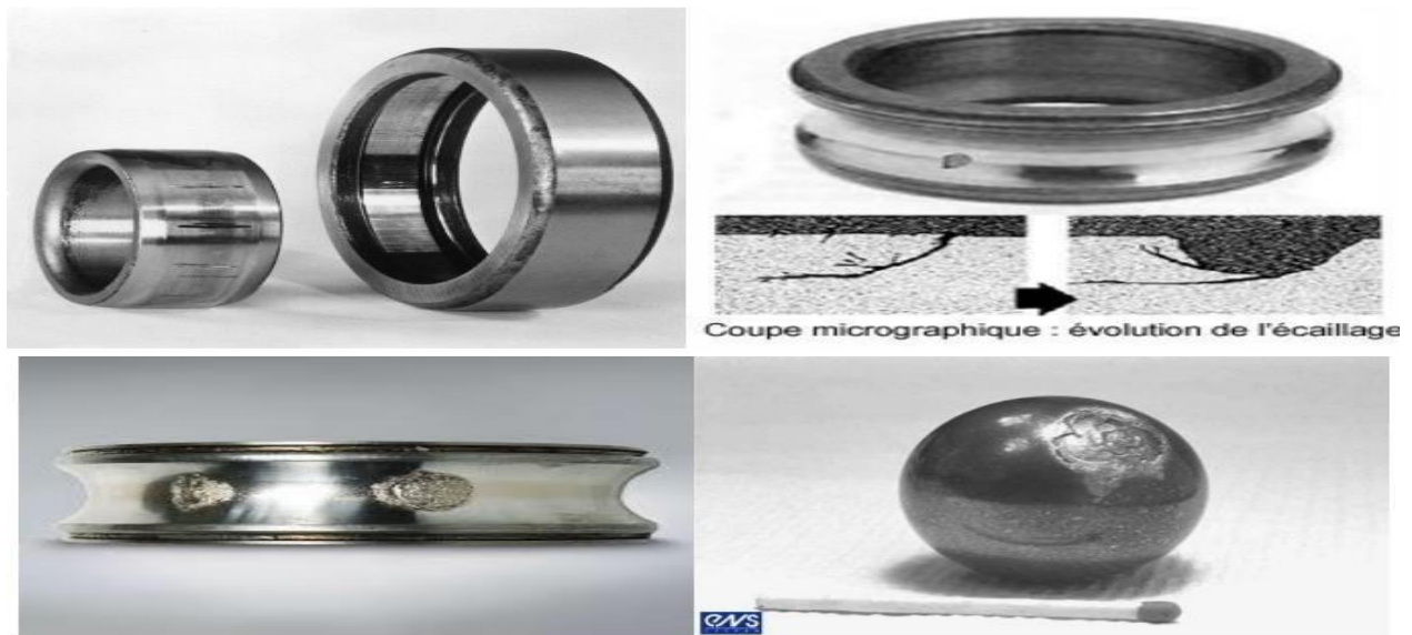
Figure II.10 Défauts de roulements [16].
