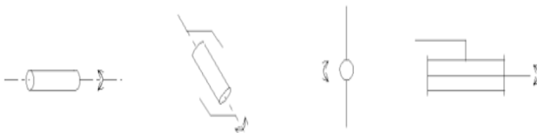
Fig.1.7. Symbole de les articulations rotoïdes .
