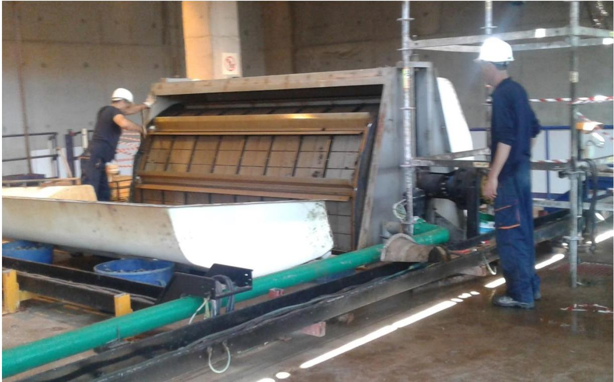
Figure III .6 : Filtres rotatifs
