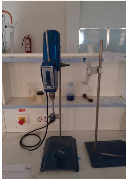
Photo IV.2: Appareillage pour essai au bleu de méthylène. (21/02/2022)
