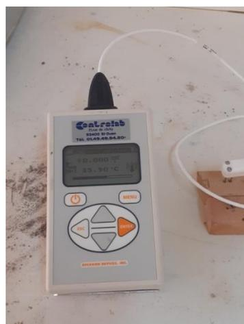
**Photo V. 14 : Essai de conductivité thermique (30/03/2022)**
