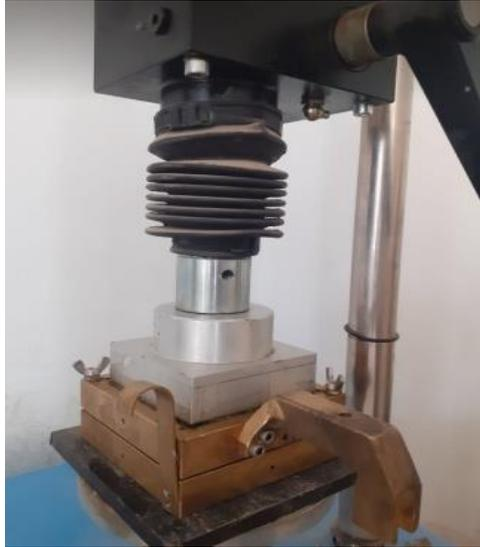
**Photo V. 8 : Façonnage de la brique (14/03/2022)**
