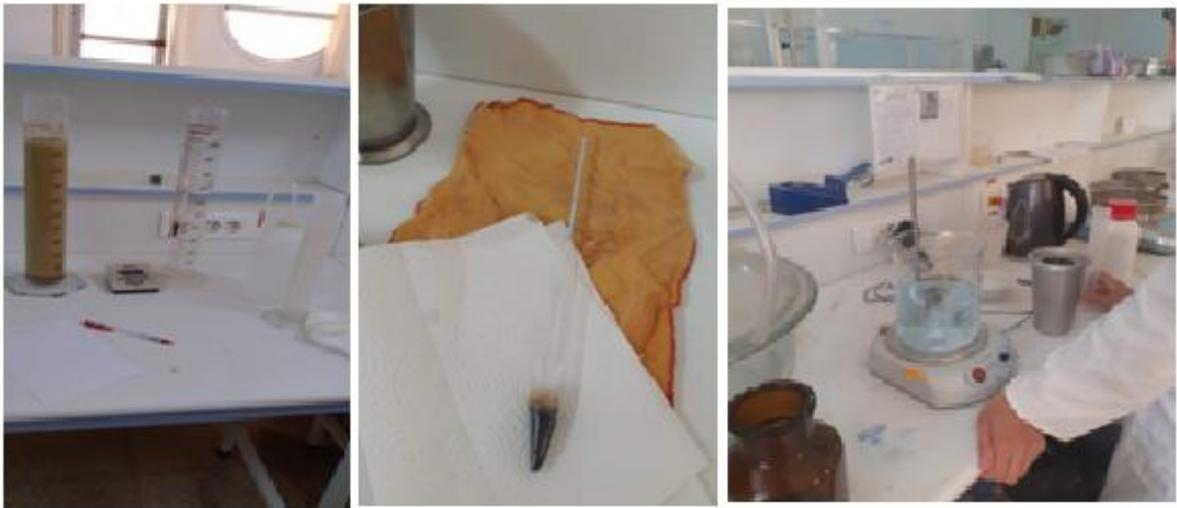
**Photo IV.1 : Appareillage sédimentation LTPE-UAT (07/03/2022)**
