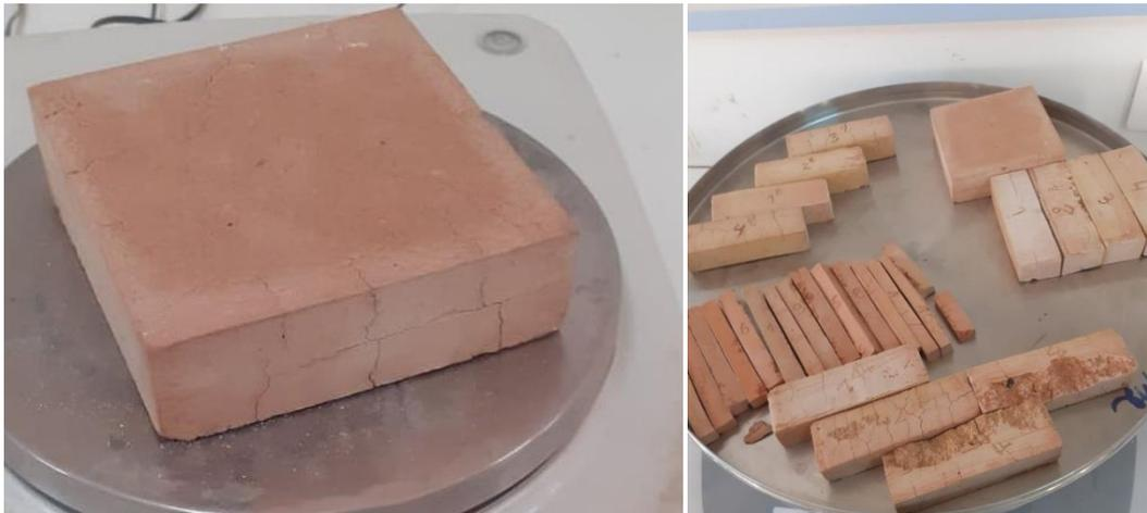
**Photo V. 11 : Echantillons de la brique après cuisson (24/03/2022)**
