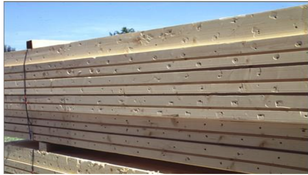
Figure I.36 : schéma de clouage.
