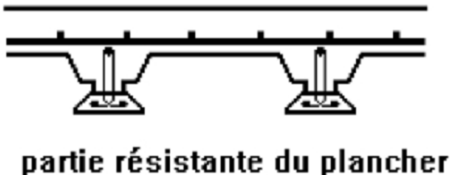
Figure I.14 : partie résistante du plancher
