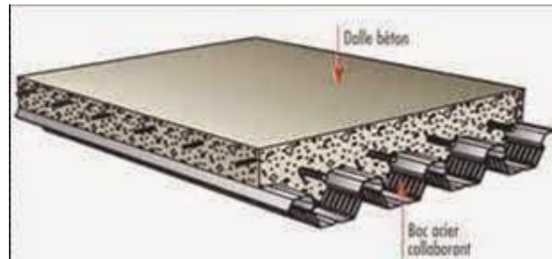
Figure I.8 : Planchers mixtes acier béton
