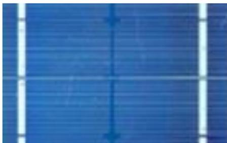
Figure (I.6) : Cellule au Silicium Mono-cristallin [15].
