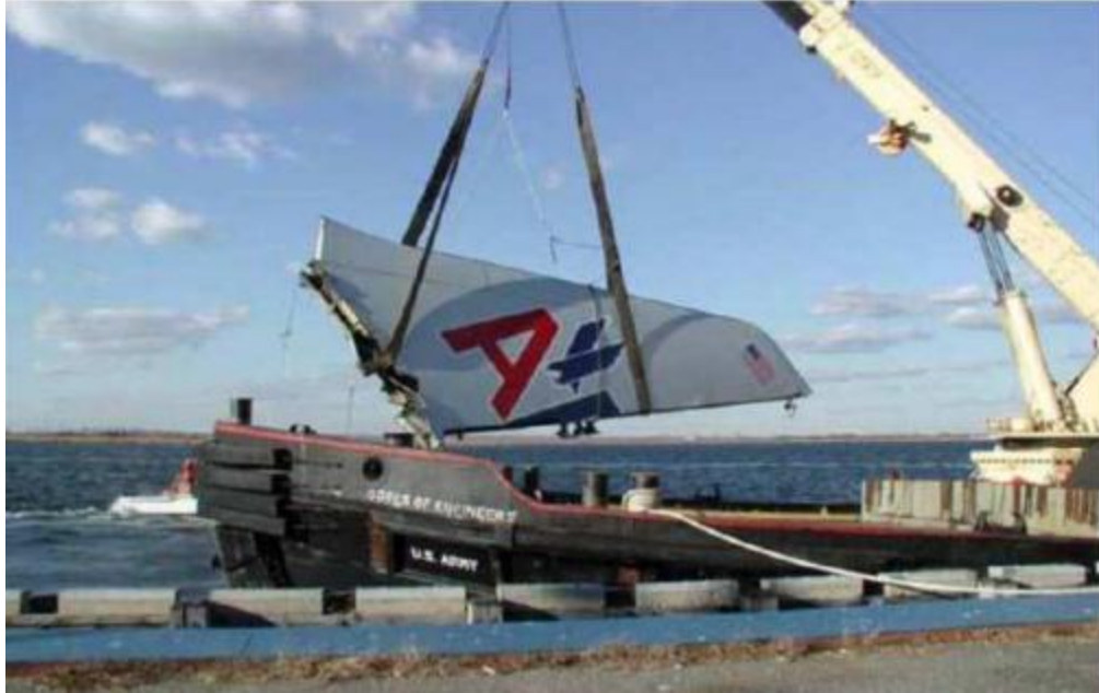
Figure I.2. Stabilisateur vertical, qui s'est séparée du vol American Airlines 587, conduisant à un accident mortel [5].
