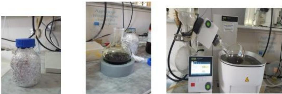
**Figure 17:** Evaporation de l'extrait par le Rota Vapeur.
