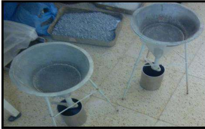
Figure 23: Détermination de la masse volumique apparente d'un matériau
