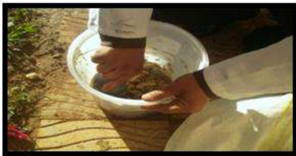
Figure 25:Lavage et séchage du sable 105°C pendant 24 H.
