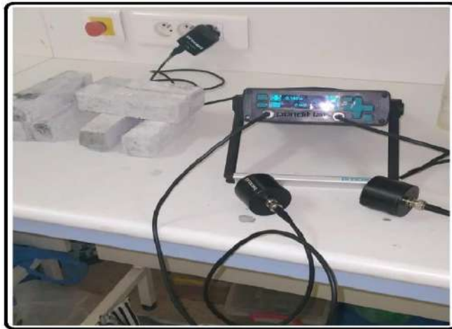
Figure 36:Appareil d'auscultation sonore « Essai d'ultrason ».
