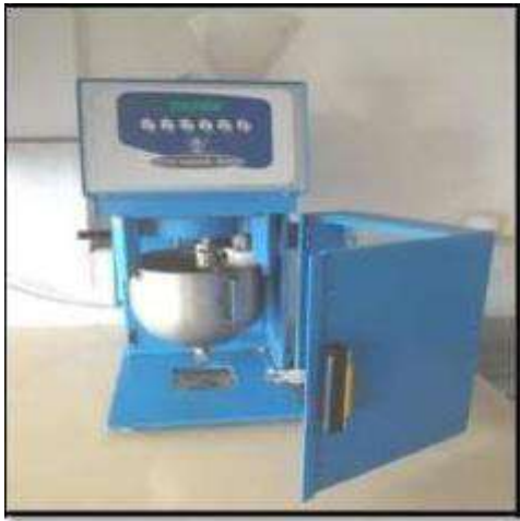
Figure 29: Malaxeur électrique utilisée dans la fabrication du mortier
