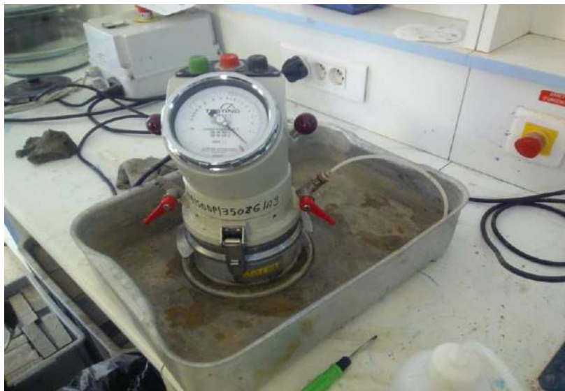
Figure 33: appareil l'aéromètre à mortier « mesure de la teneur en air ».
