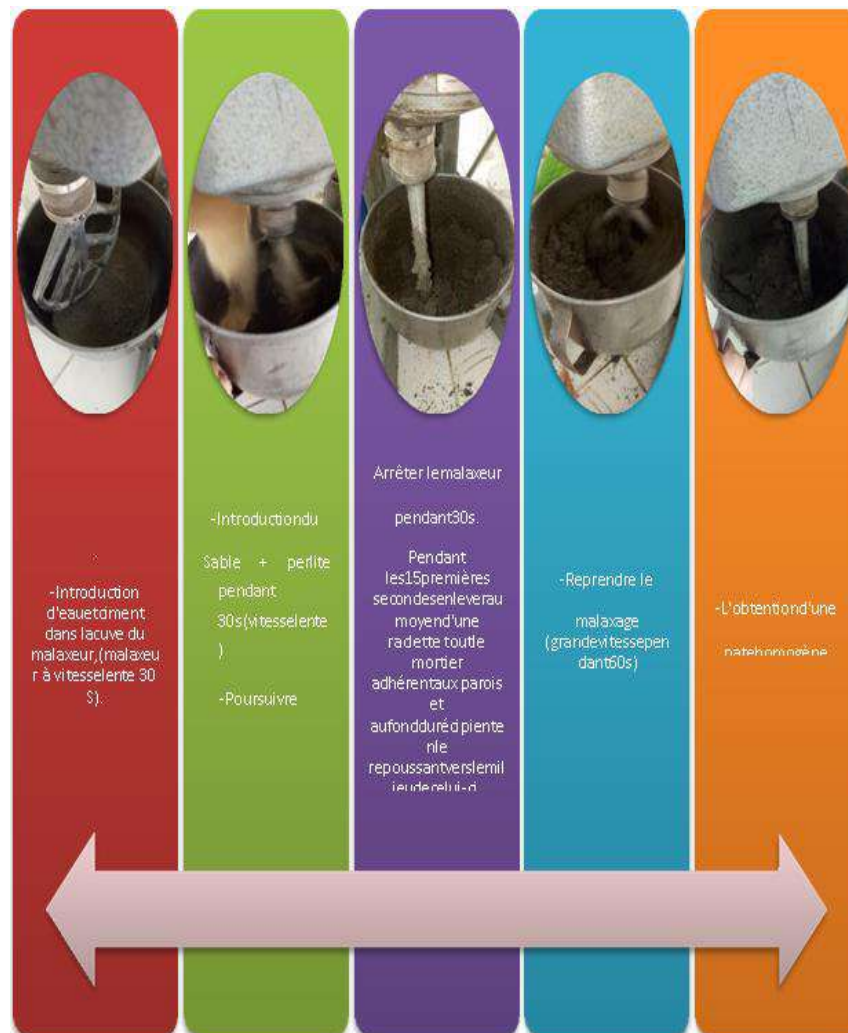
Figure 31: Les étapes de malaxage du Mortier normalisé .
