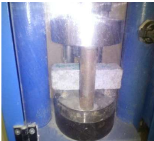
Figure 34:L'Essai de traction par flexion.
