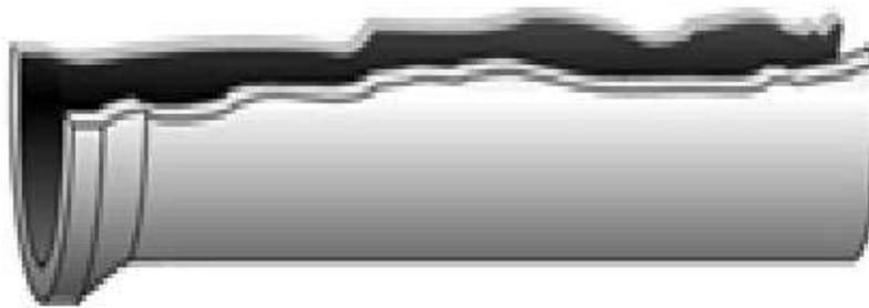
Figure 22 : Fissure dans les joints de soudure.[19]
