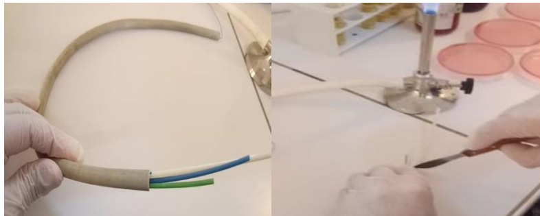
Figure 3 : Préparation de l'échantillon de la tubulure de l'unité dentaire de la clinique Al Sebbah EPSP Ain Temouchent
