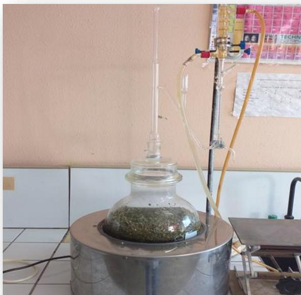
**Figure 11** : Montage d'hydrodistillation Clevenger (**Image originale**).
