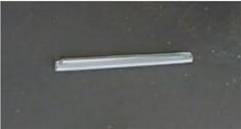
Figure II. 15. Protection d'épissure.
