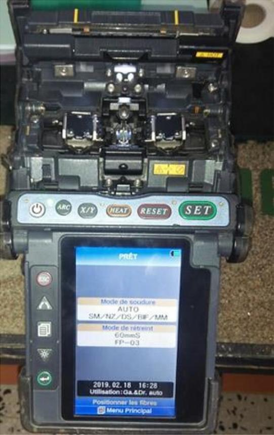
Figure II. 13. fusionneuse
