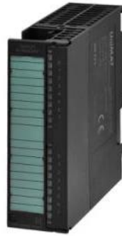
Figure II-7 : Exemple d'un module d'entrées (Sm321) [W16]
