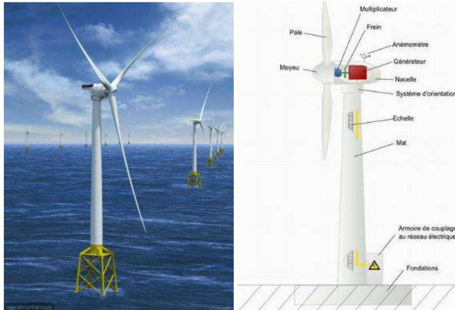
Figure I.8 : Aérogénérateur à axe horizontal.
