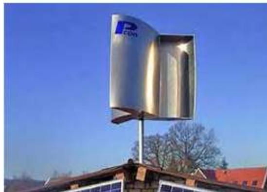
Figure I.7 : éolienne à axe vertical de type Savonius.
