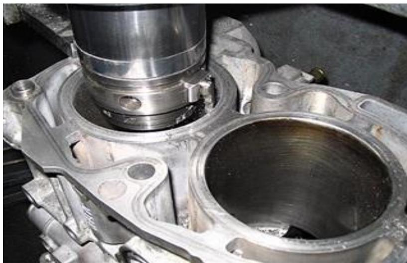
*Figure 27 : Le chemisage du bloc cylindre [4]*
