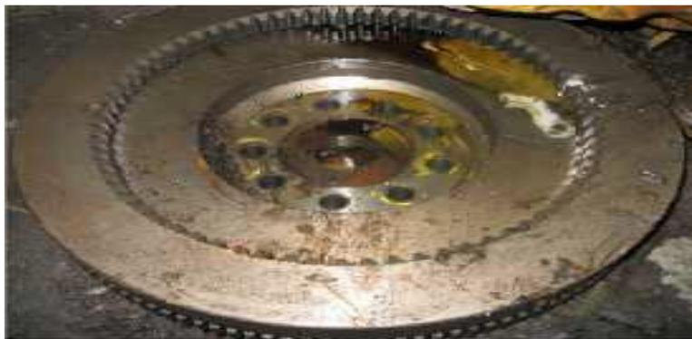
*Figure 9 : Le Volant moteur [4]*
