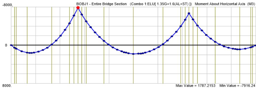
Figure 75: Diagramme des moments fléchissant de la combinaison 1 (ELU) au niveau de tablier
