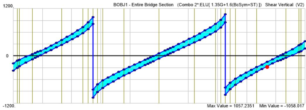
Figure 77: Diagramme des efforts tranchants de la combinaison 2 (ELU) au niveau de tablier
