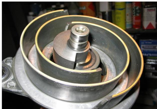
**Figure II.10 :** Compresseur spirale [12].
