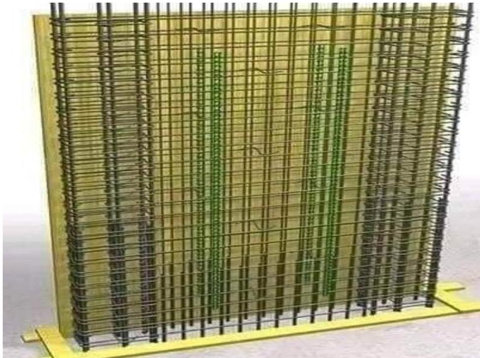
**Figure VI-3: Schéma de ferrailage des murs voiles en 3D.**
