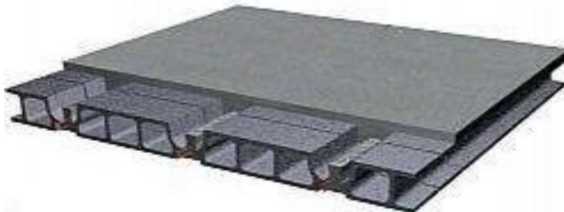
**Figure I-5 : plancher à corps creux.**
