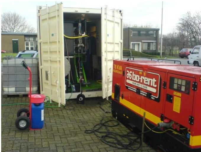
**Fig. 4.13** Unité de traitement d'eau de surface (ultrafiltration/osmose inverse)
