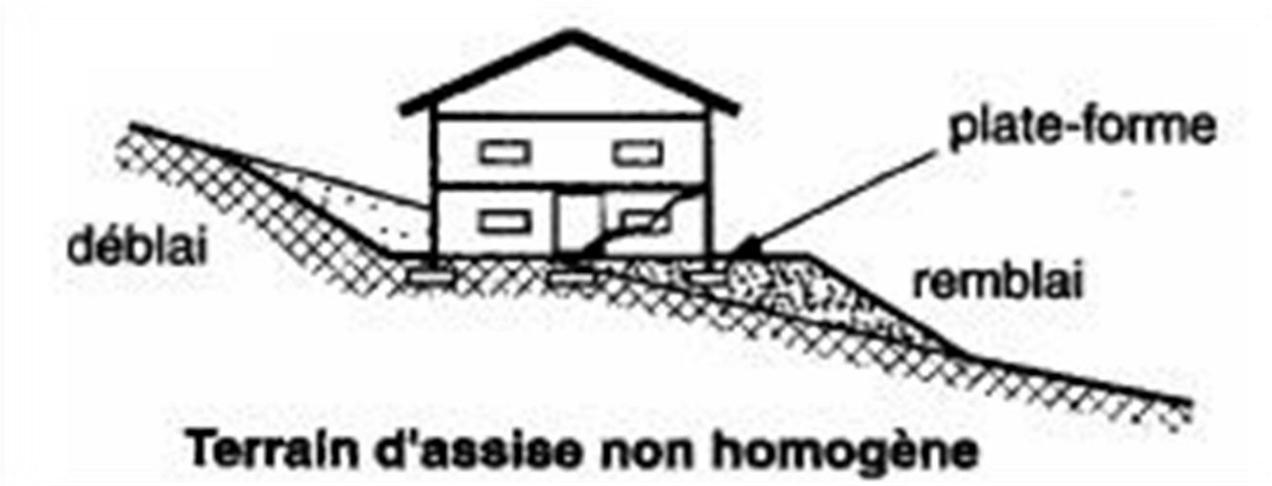
Fig. 1.3 terrain d'assise non homogène [2]
