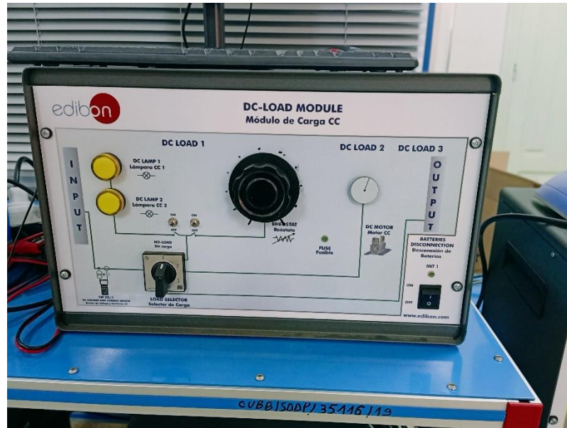
Figure IV.5 : Schéma de module de charges CC
