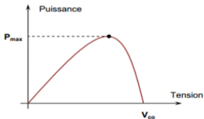
Figure III.19 : Caractéristique Puissance (P)-Tension (V) d'une cellule photovoltaïque [1, 12, 14].
