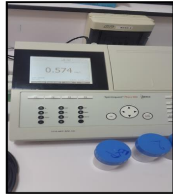
Photo 8 : spectrophotomètre :réactif utilisé dans la mesure de chlore.
