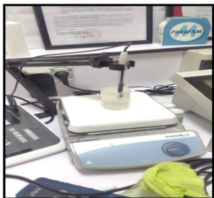
Photo 2 : la mesure de pH par le pH-mètre et le pH-mètre numérique.
