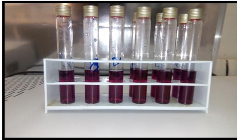
Figure 19 : les résultats des tests en tubes du milieu BCPL pour les coliformes.
